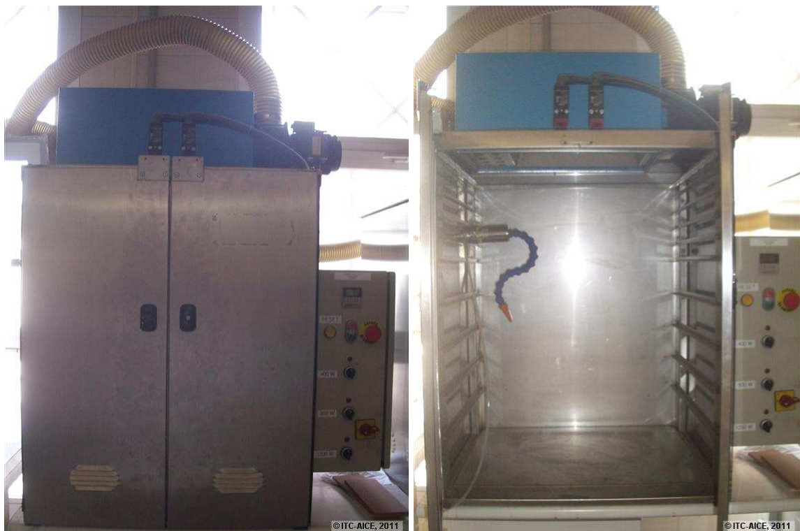
Figura 2 Fotografías de la cámara de insolación de lámpara de vapor de mercurio empleada.
