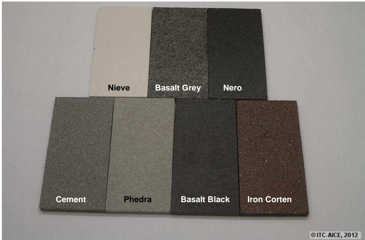
Figura 3 Aspecto de las baldosas tras 28 días de insolación.
